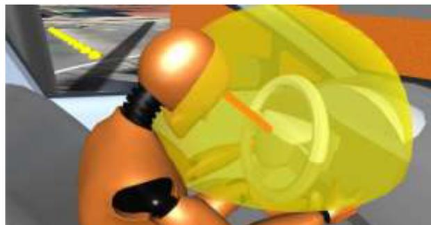
**Figura 36.** Simulação computacional, com vista para a trajetória (na cor vermelha) do fragmento que atingiu a vítima.
