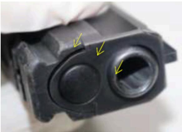
**Figura 9.** Manchas de sangue impregnadas na arma de fogo após 103 dias do experimento.
