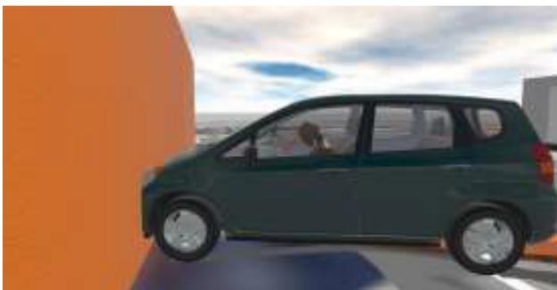
**Figura 35.** Simulação computacional, com destaque para ilustração da posição do condutor/vítima e a trajetória do fragmento que se desprende do sistema do airbag.
